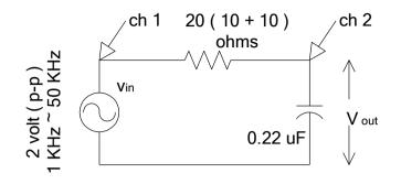
Figure 2 : RC Lowpass Filter
