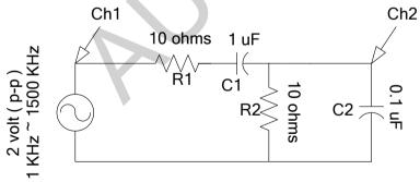
Figure 4 : RC Bandpass Filter
